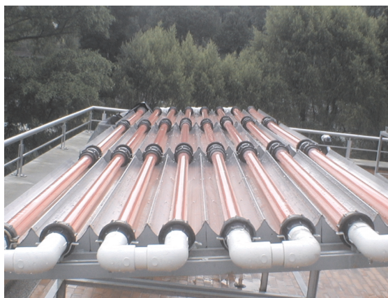
Foto1. Colector solar cilindro parabólico empleado para tratar el agua coloreada con el colorante rojo amaranto.
