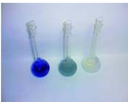
**Foto 15. Disminución del color para el agua residual industrial ensayo AM3R3**
