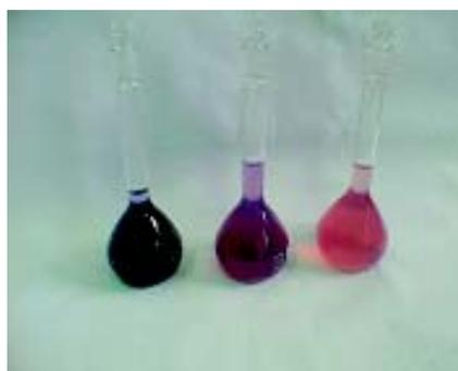
**Foto 14. Disminución del color para el agua residual industrial ensayo AM3R2**
