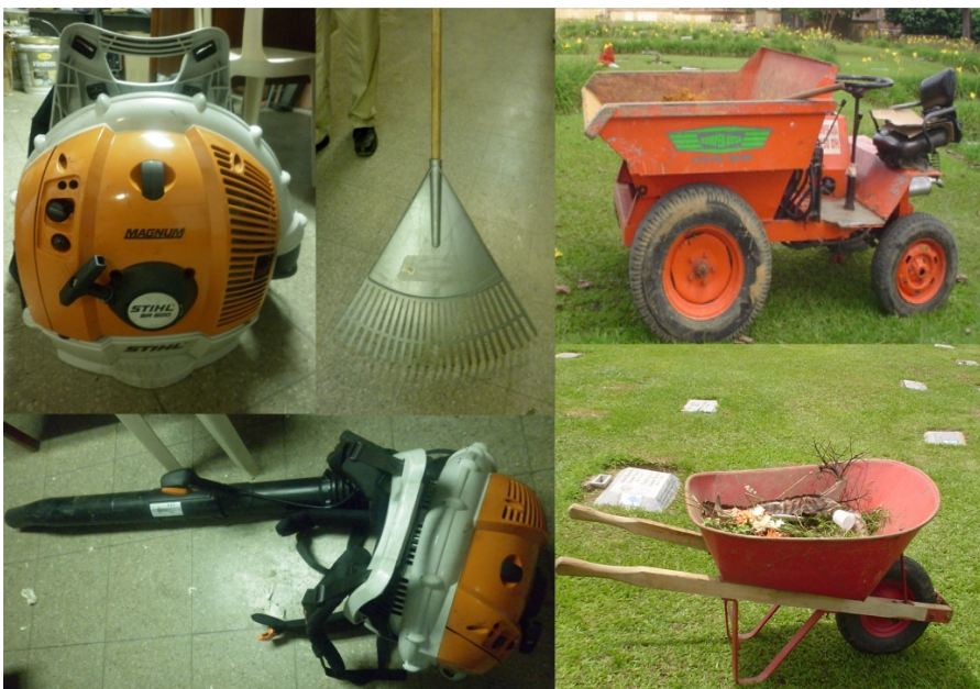
Ilustración 4. Herramientas y equipos utilizados en la recolección de los residuos sólidos.
