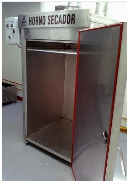
Figura 17. Horno secador y precocido. Fuente: Ci Talsa
