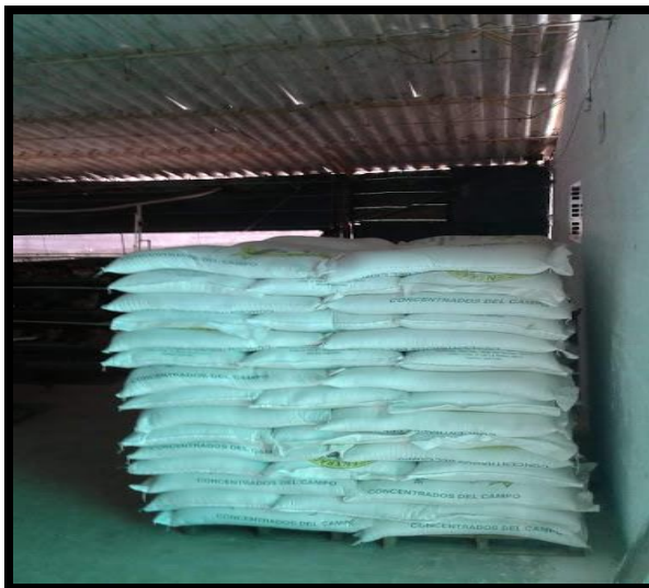
Figura 50. Almacenamiento de concentrado delimitado de la pared y ubicado sobre estibas.
