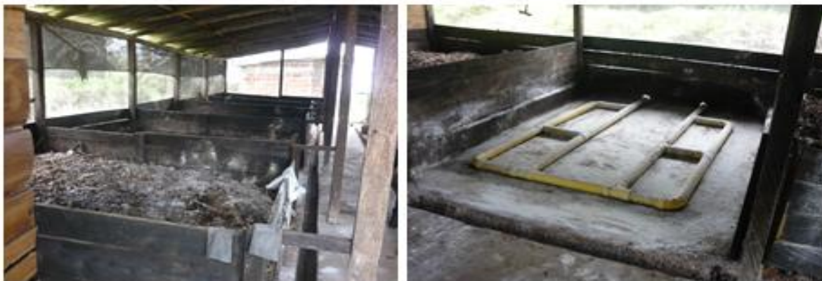
Ilustración 9 sistema de compostaje con aireación forzada en Granda Antioquia
