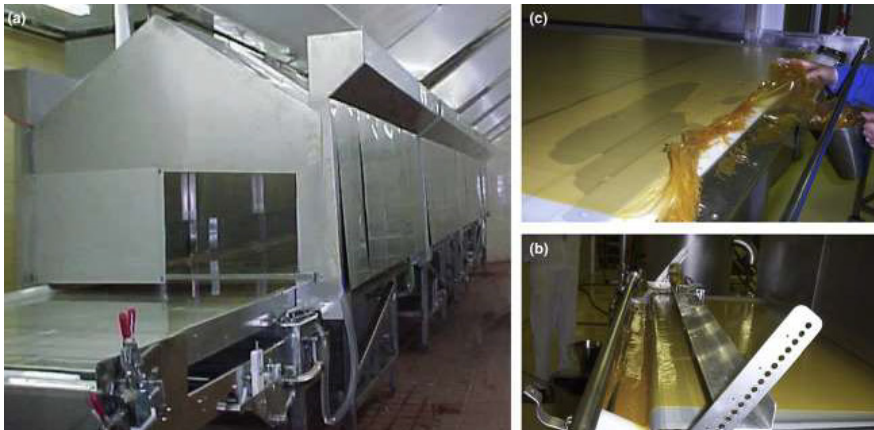
Figura. Fotos de: (a) una instalación secadora RW a escala comercial (RWD5 Modelo, MCD Technologies, EE. UU.), (b) al final de alimentación húmeda de la secadora, y (c) el extremo de salida del producto secado de la secadora
