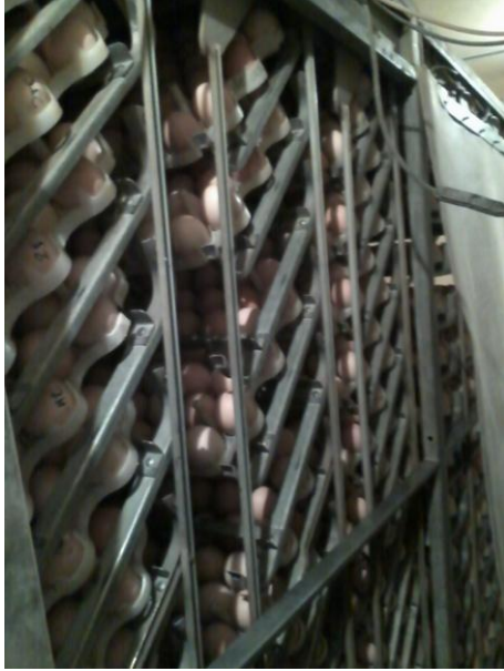
Ilustración 5. Función de volteo de huevos
