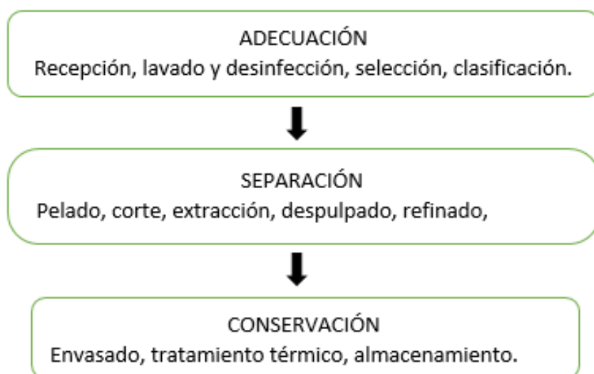
Figura 1. Flujo de Operaciones para la Elaboración de Productos a base de Pulpa de Fruta
