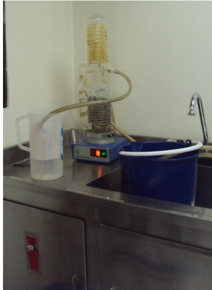
Foto 5. Montaje para medición del caudal del destilador
