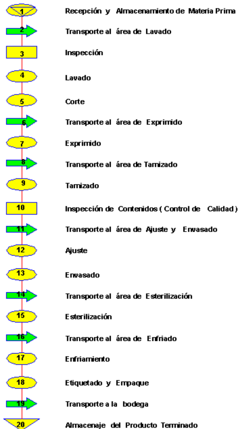
Figura 10. Diagrama de flujo de proceso de elaboración del producto
