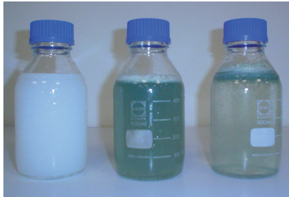
Foto 1. Apariencia del agua residual durante el proceso de electrocoagulación: sin tratamiento (izquierda) y con tratamiento a los 10 (medio) y 15 minutos (derecha).
