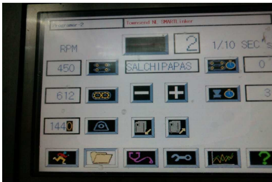
Fotografía 2. Parametros de la termoformadora para alcanzar la torsion deseada
