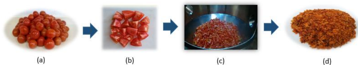
Figura 8. (a) Materia prima (b) Cortes del tomate para secado (c) Tomate puesto en el secador de lecho fluidizado (d) Tomate seco para extracción por fluidos supercríticos.
