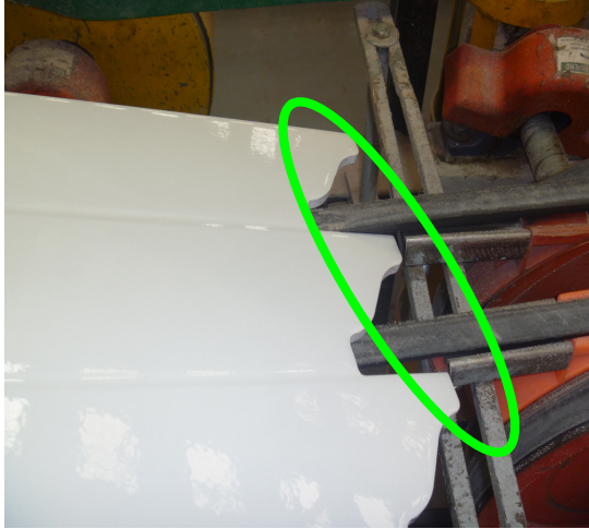
Figura 11. Atrancamiento de la baldosa al momento de ser abastecida.
