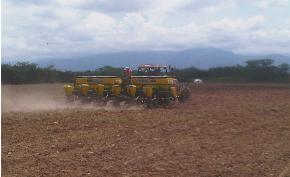
Foto 7. Sembradora neumática de precisión de 6 surcos
