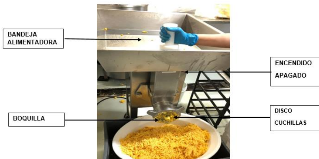
Ilustración 4. Proceso de molienda del maíz.
