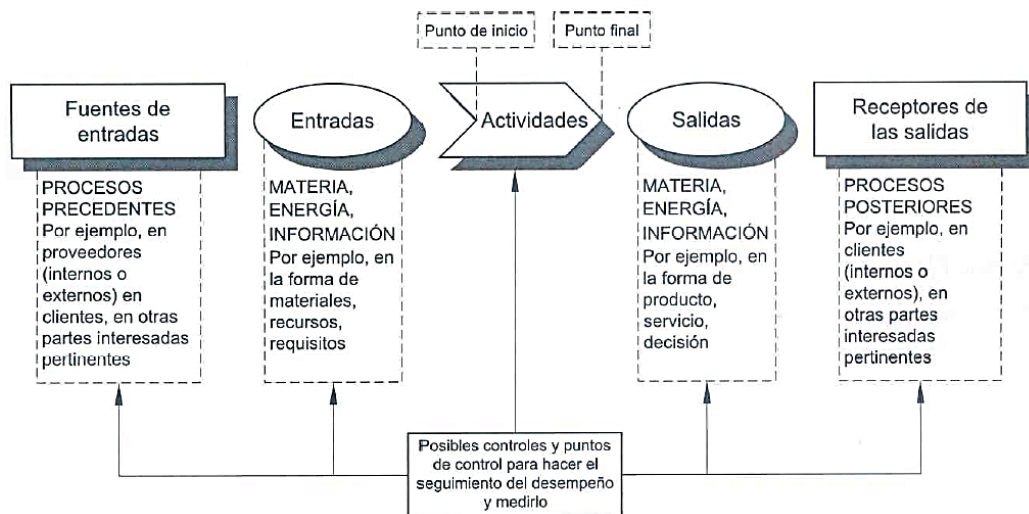
Figura 3. Representación esquemática de los elementos de un proceso
