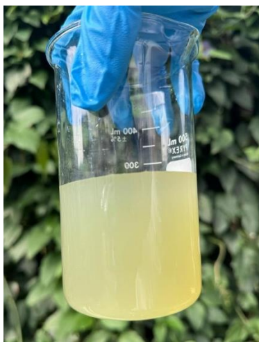
Ilustración 8. Fotografía de la salida del tratamiento fisicoquímico.
