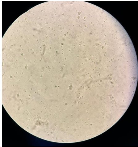
Ilustración 18. Observación microscópica del reactor biológico (40x). Se aprecian flóculos y bacterias dispersas.
