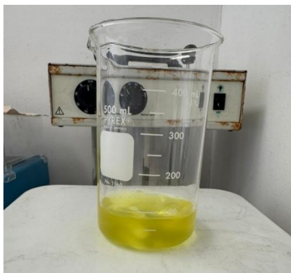
Ilustración 14. Fotografía muestra (10 mL) + agua destilada (90mL) + K 2 CrO 4 (1ml)
