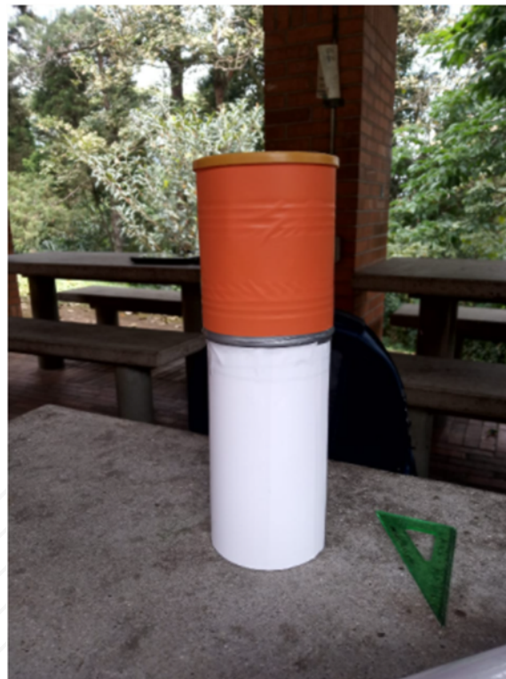
Imagen 1: Prototipo desarrollado a partir de material reciclado principalmente: recipiente metálico, tubo de PVC, cinta industrial y contac de colores. Tiene una capacidad de 800 colillas de cigarrillo.
