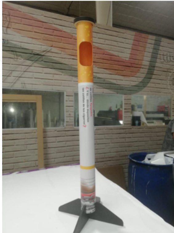
Imagen 2: Prototipo publicitario, que cuenta con cenicero en la parte superior y mensajes alusivos que buscan hacer reflexionar sobre botar los cigarrillos en la fuente. Realizado a partir de un tubo de PVC. Con capacidad para almacenar aproximadamente 5000 colillas
