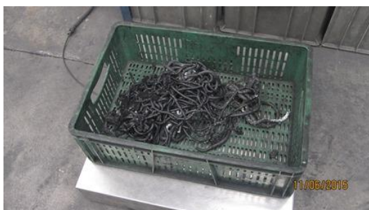
Imagen 15. Pesaje de colas de caucho.
