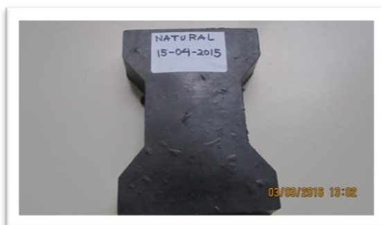
Imagen 23. Adoquín resultado del segundo ensayo. Mezcla natural
