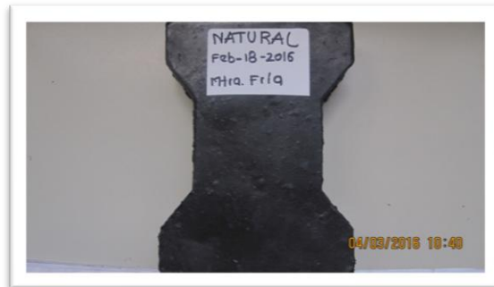
Imagen 28. Producto no conforme, adoquín realizado con mezcla natural fría.
