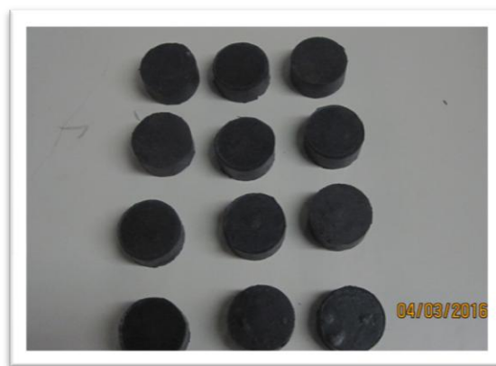
Imagen 32. Botones realizados con mezcla de caucho natural (colas)
