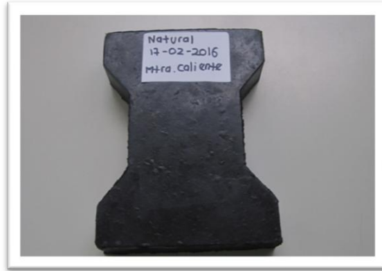
Imagen 27. Producto conforme, adoquín caucho natural.
