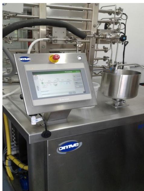
Figura 7. Compartimientos Pasteurizador marca Omve: sistema HTST-UHT System HT-220
