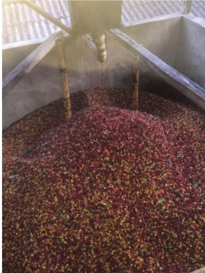
Foto 4. Ingreso del café al tanque sifón o tolva
