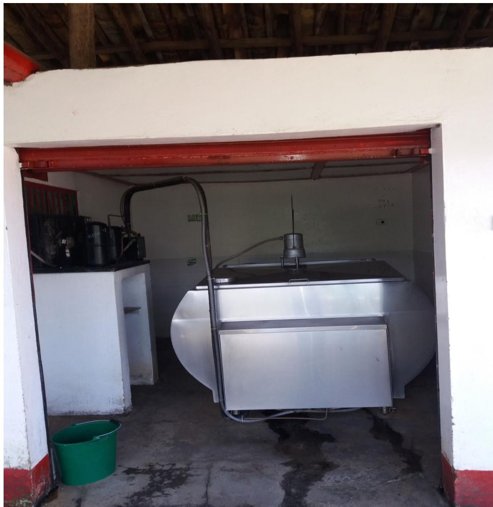
Foto 4. Tanque de enfriamiento de leche.
