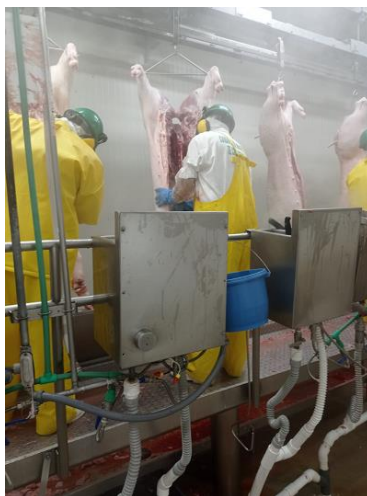
Figura 15. Puesto levantamiento de empella.
