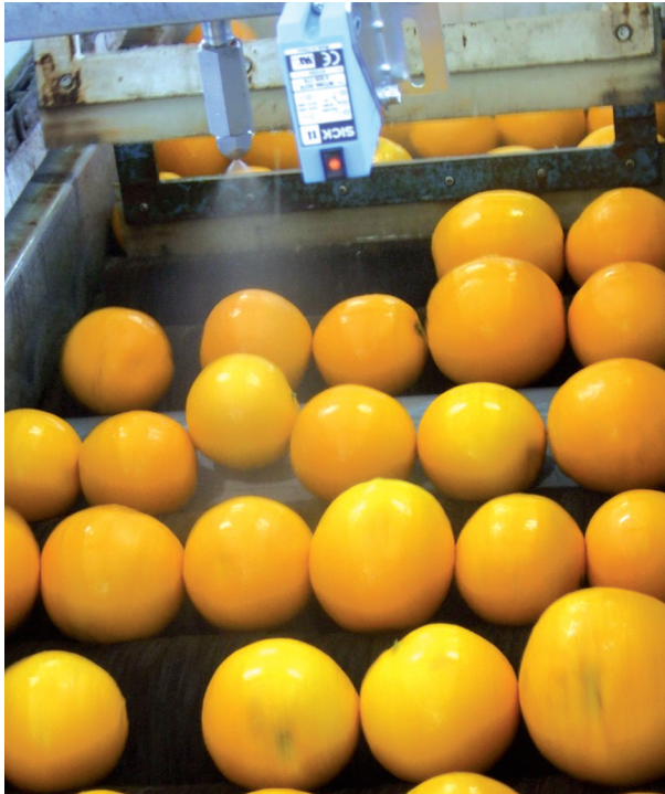
Figura 2. Aplicación de fungicida mezclado con cera en una línea de confección de cítricos.
