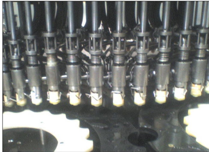
Figura 6. Válvulas y mangueras de llenado
