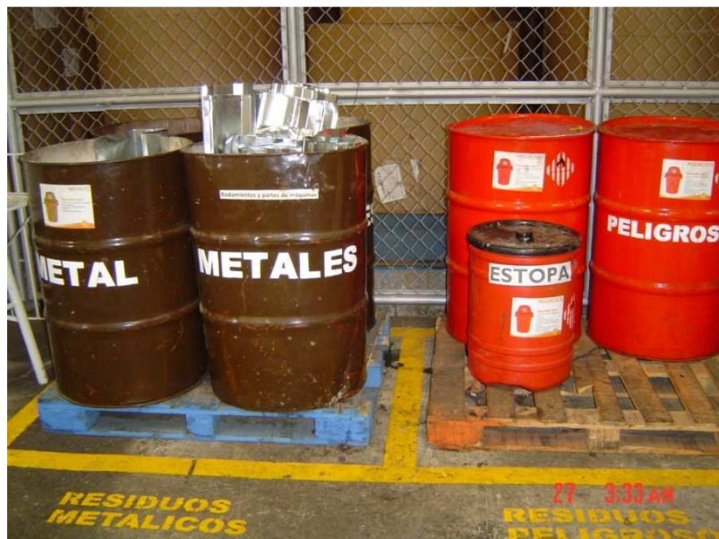
Imagen 14. Señalización de RESPEL y residuos metálicos.
