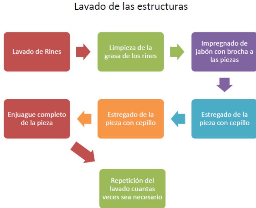
Figura 12: Etapas de lavado de estructuras
