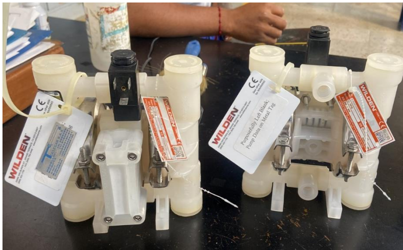
Imagen 3. Bombas Dosificadoras con doble diafragma
