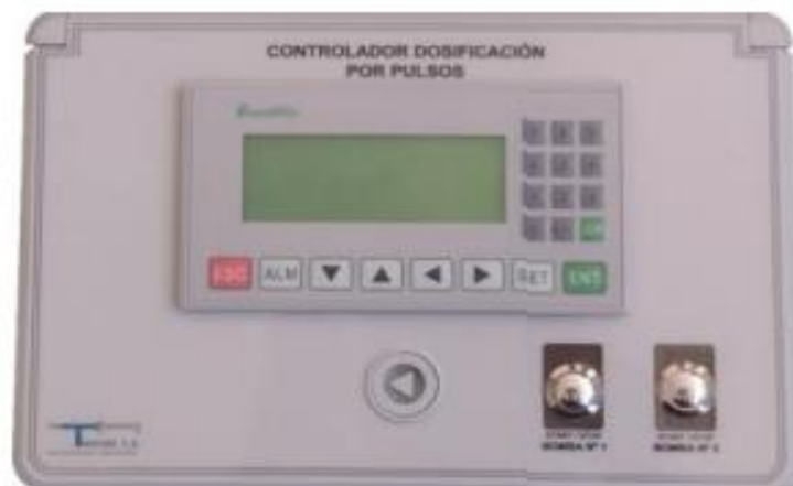
Imagen 4. Controlador de dosificación por pulsos
