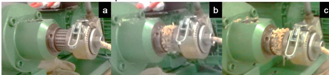
Figura 11. Perdida de material por orificios de salida de aceite
