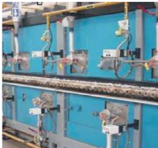
Foto 3. Horno de cocción de piezas cerámicas con gas natural
