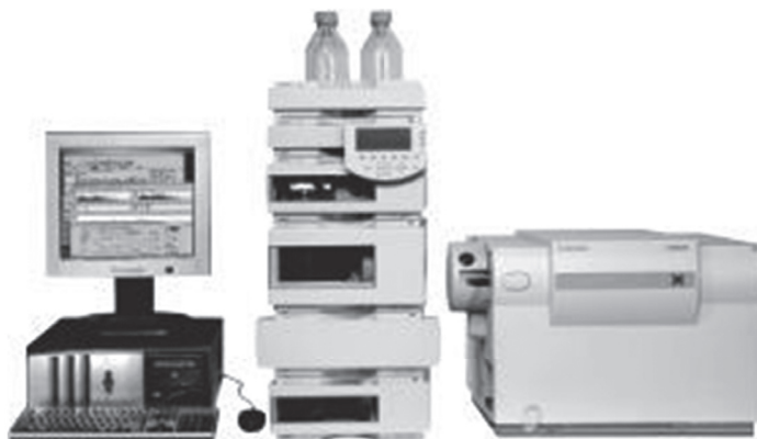
Figura 4. Equipo de HPLC/MS marca Agilent® serie 1200
