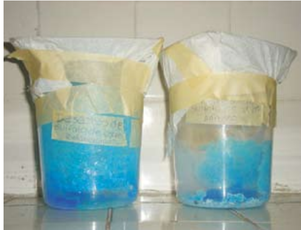
Foto 3. Evaporación de los desechos de sulfato de cobre a temperatura ambiente
