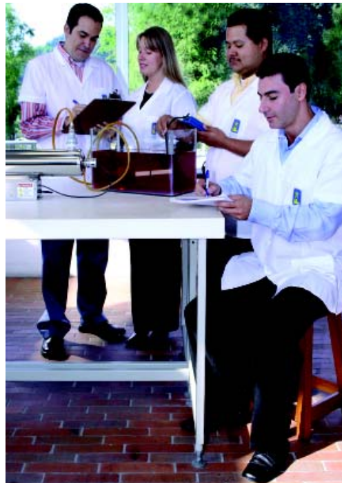
Foto 1. Montaje con lámpara UV realizado para la degradación de colorantes
