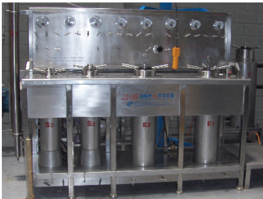
Foto 1. Equipo de Fluidos Supercr ticos marca Guangzhou Masson New Separation Technology Co., Ltd., utilizado en la experimentaci n.
