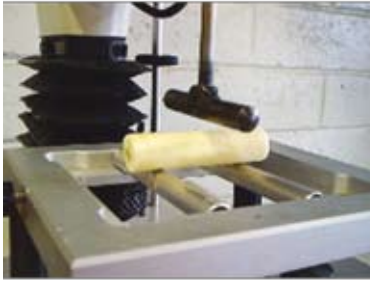
Figura 4. Prueba módulo elástico a flexión y Vista esquemática del ensayo de flexión.
